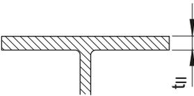
Steel:  $t_{II} \geq 4 \text{ mm}$
