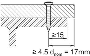
Edge distance:  $c \geq 15 \text{ mm}$
