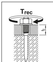
$$T_{rec} \leq 4 \text{ Nm}$$
