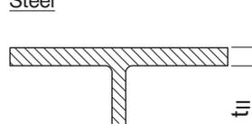
$$t_{II} \geq 4 \text{ mm}$$
