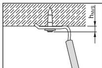
$h_{NVS} = 5.5\text{--}8.5\text{ mm}$
