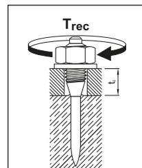
$$T_{rec} \leq 6 \text{ Nm}$$
